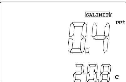
设定的温度系数是无关的, 在此显示模式时会有“**SALINITY**”字样显示, 而其单位为 **ppt** (参考左图), 若只显示“ppt”而无“**SALINITY**”字样显示时, 则是 TDS 显示模式, 两种显示请注意之间的分别。
