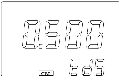
总溶解固体量因子乘以有温度补偿的电导度值即是总溶解固体量，总溶解固体量常数可设定的范围是 0.300 到 1.000 之间，使用者必须依实验或经验去获得正确值，否则可以设定为 0.500 去获得粗略的总溶解固体量。
