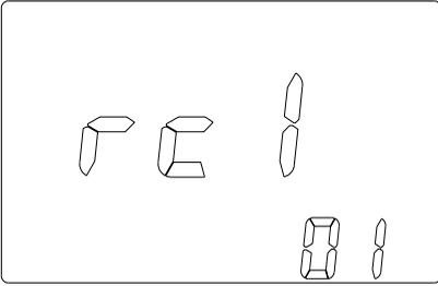
2. 使用者可以按 [ENTER] 键确认进入回校显示, 此时显示器的左上方会显示 "RC", 主显示区会显示电导度和温度值, 再按 [ENTER] 键一次则会显示总溶解固体量和温度值, 再按 [ENTER] 键一次则会显示盐度值, 再按 [ENTER] 键一次又回到电导度和温度值。
