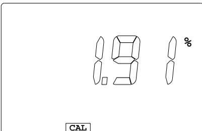
1. 在完成探棒基本常数步骤后, 即可进入温度系数的设定, 亦可在电导度或 TDS 显示模式时按 [CAL] 键再按 [MODE] 键亦可进入温度系数的设定, 此时 LCD 会显示 1.91% 的工厂
