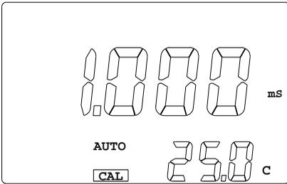
3. 使用者可以按 [ ] 或 [ ] 键可以调整主显示区电导度值，使与使用的标准溶液的电导度值(25 时)相同。
